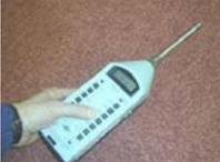
**Exposimètre** : autonome, portable par un travailleur
